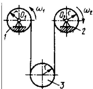
Блоки 1 и 2 вращаются вокруг неподвижных осей  $O_1$  и  $O_2$  с угловыми скоростями  $\omega_1 = 4$  рад/с и  $\omega_2 = 8$  рад/с. Определить угловую скорость подвижного блока 3. Радиусы блоков одинаковы и равны  $r = 10$  см.
