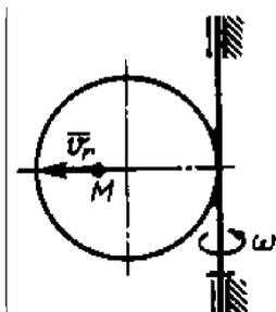
По диаметру диска, вращающегося вокруг вертикальной оси с угловой скоростью  $\omega = 2t$ , движется точка  $M$  с относительной скоростью  $v_r = 4t$ . Определить модуль ускорения Кориолиса точки  $M$  в момент времени  $t = 2$  с.
