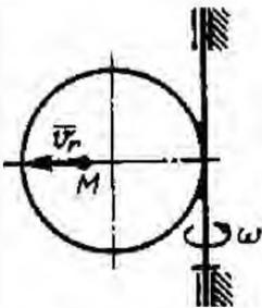
По диаметру диска, вращающегося вокруг вертикальной оси с угловой скоростью  $\omega = 2t$ , движется точка  $M$  с относительной скоростью  $v_r = 4t$ . Определить модуль ускорения Кориолиса точки  $M$  в момент времени  $t = 2$  с.
