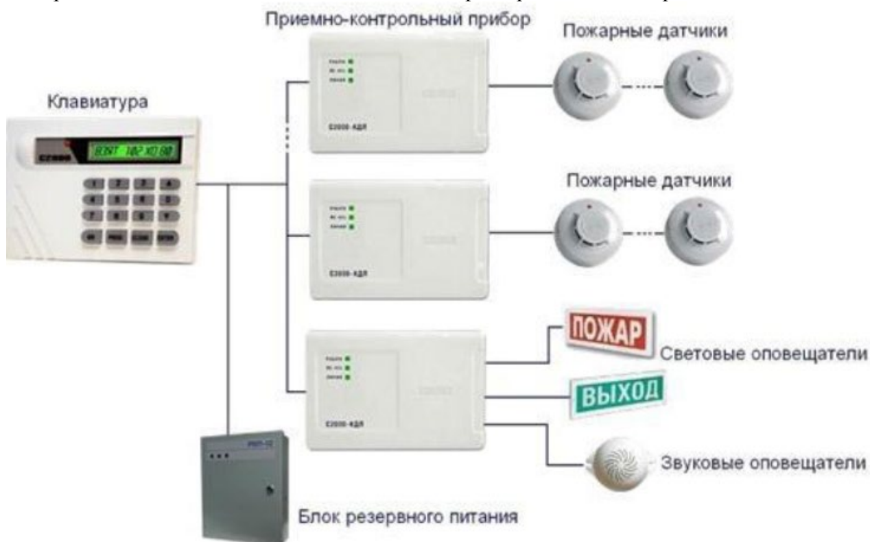
Рис.1.7 Обобщенная схема системы пожарной сигнализации
