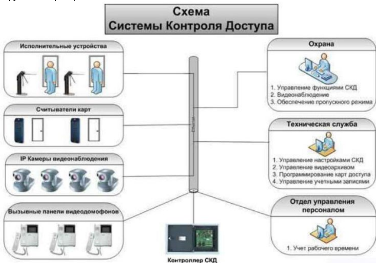
Рис. 1.10 Обобщенная структура СКУД
