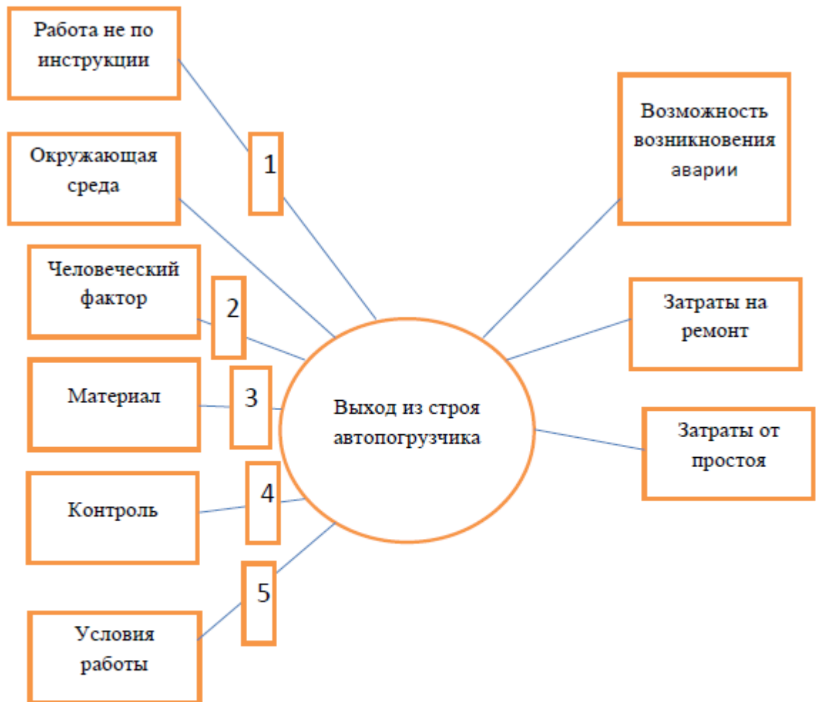
Рис. 4 - Пример выполнения диаграммы «Галстук-бабочка»: 1 – обеспечение контроля работы по инструкции; 2 – проведение обучения; 3 – проведение контроля соответствия; 4 – проведение своевременного технического обслуживания; 5 – пересмотр графика работы
