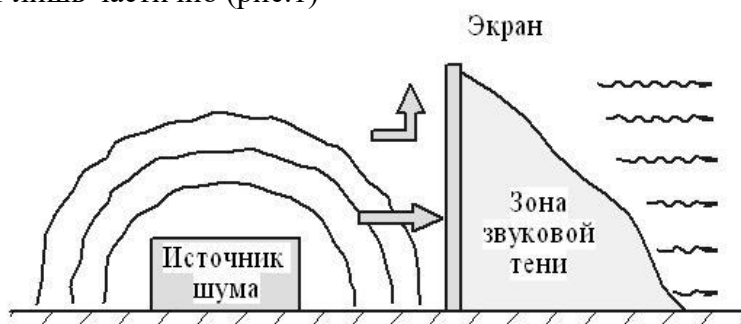
Рис. 1. Схема образования звуковой тени
