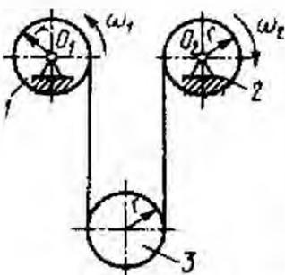
Блоки 1 и 2 вращаются вокруг неподвижных осей  $O_1$  и  $O_2$  с угловыми скоростями  $\omega_1 = 4 \text{ рад/с}$  и  $\omega_2 = 8 \text{ рад/с}$ . Определить угловую скорость подвижного блока 3. Радиусы блоков одинаковы и равны  $r = 10 \text{ см}$ .
