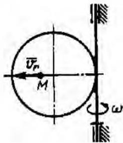
По диаметру диска, вращающегося вокруг вертикальной оси с угловой скоростью  $\omega = 2t$ , движется точка  $M$  с относительной скоростью  $v_r = 4t$ . Определить модуль ускорения Кориолиса точки  $M$  в момент времени  $t = 2c$ .
