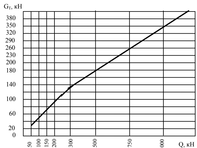
Рис. 5.4. Вес тележки в зависимости от грузоподъемности крана
